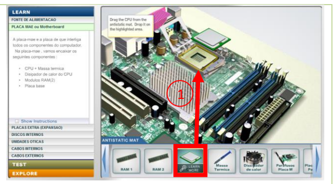
Arrasta o CPU para o Socket na motherboard (1).
